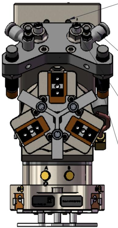
连接板跟桁架的末端固定后可以通过松开这两个紧定螺钉使旋转头做X向调节位置,待位置准确后,拧紧此两个紧定螺钉。
