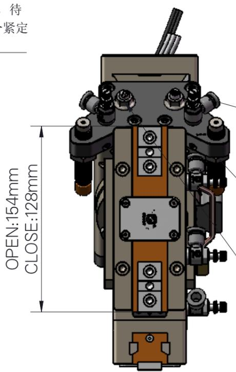
排气式节流阀,气管规格为4mm
