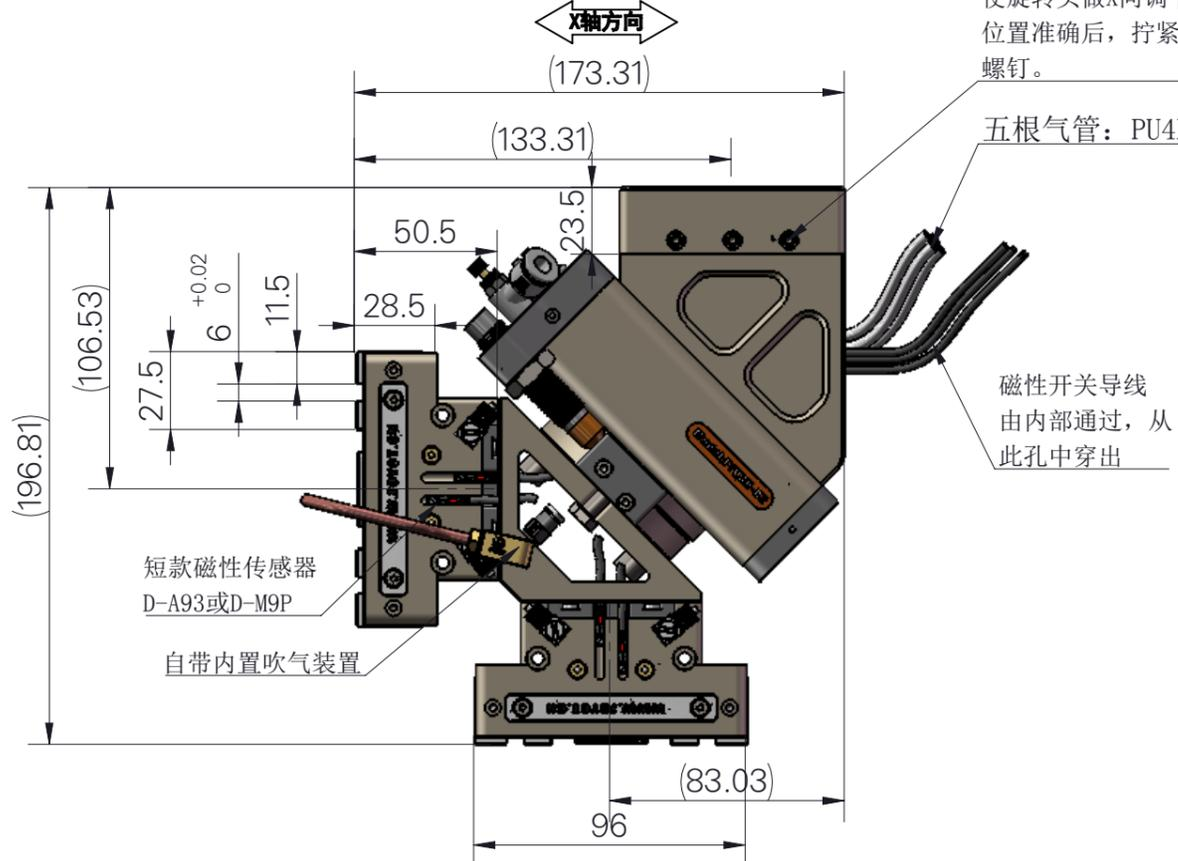
当夹爪采用接近开关时可通过调节该螺钉确定夹爪打开和夹紧工件时的位置信号, 当拧到极限位置后, 切不可继续用力拧动, 否则会造成损坏感应块的风险
