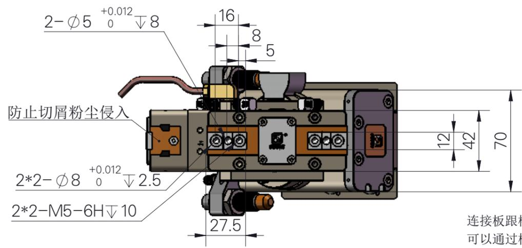
连接板跟桁架的末端固定后可以通过松开这三个紧定螺钉使旋转头做X向调节位置, 待位置准确后, 拧紧此两个紧定螺钉。
