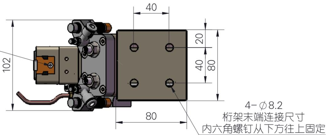
排气式节流阀, 气管规格为4mm
